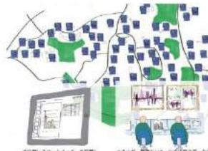
各世帯にスマートメーターを設置し、自動的にエネルギー管理が行える
